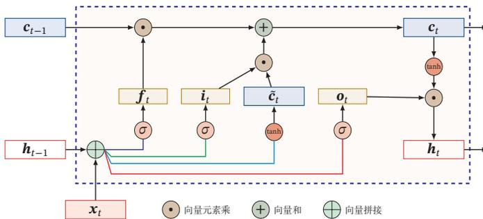
图 6.7 LSTM 网络的循环单元结构
