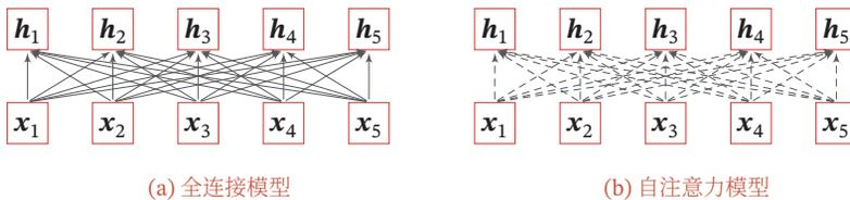
图 8.5 全连接模型和自注意力模型
