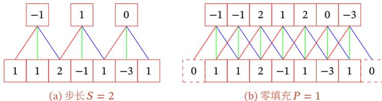
图 5.4 卷积的步长和零填充 (滤波器为  $[-1, 0, 1]$ )
