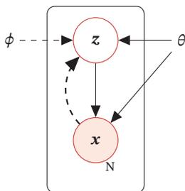
实线表示生成模型，虚线表示变分近似。
