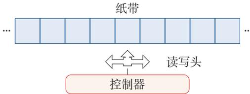
图 8.8 图灵机结构示例
