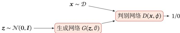
图 13.8 生成对抗网络的流程图
