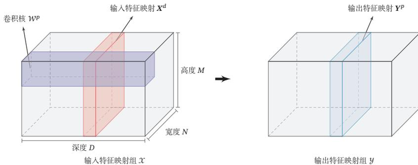
图 5.6 卷积层的三维结构表示
