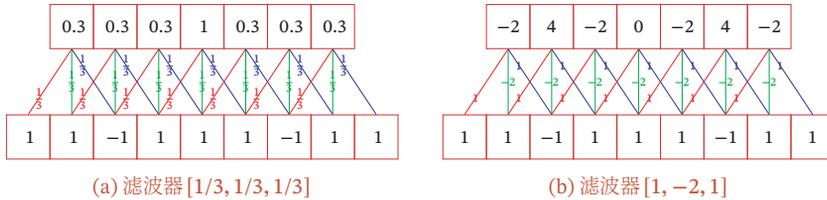
下层为输入信号序列, 上层为卷积结果. 连接边上的数字为滤波器中的权重. 左图的卷积结果为近似值.
