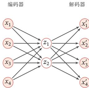
图 9.2 两层网络结构的自编码器
