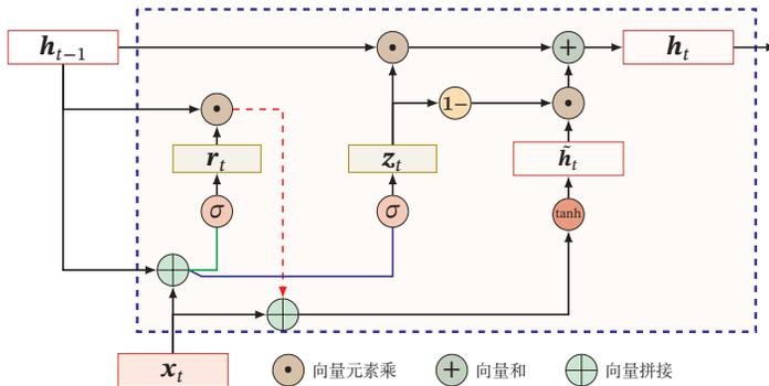
图 6.8 GRU 网络的循环单元结构
