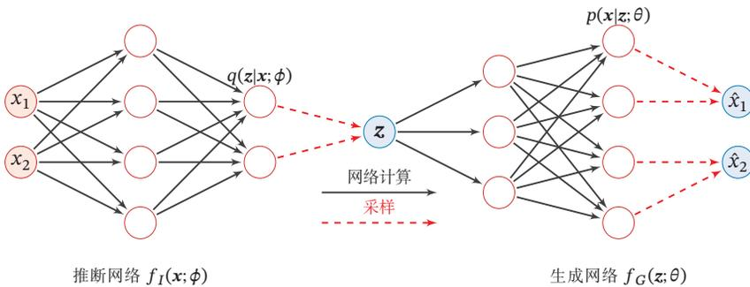
图 13.4 变分自编码器的网络结构
