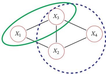
图 11.7 无向图模型中的团和最大团
