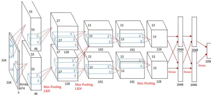
图 5.12 AlexNet 网络结构<sup>1</sup>
